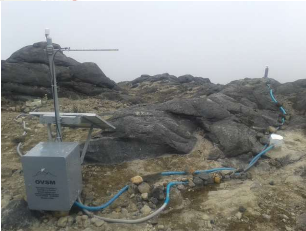
Figura 4. Estación multiparamétrica RECIO 3.
