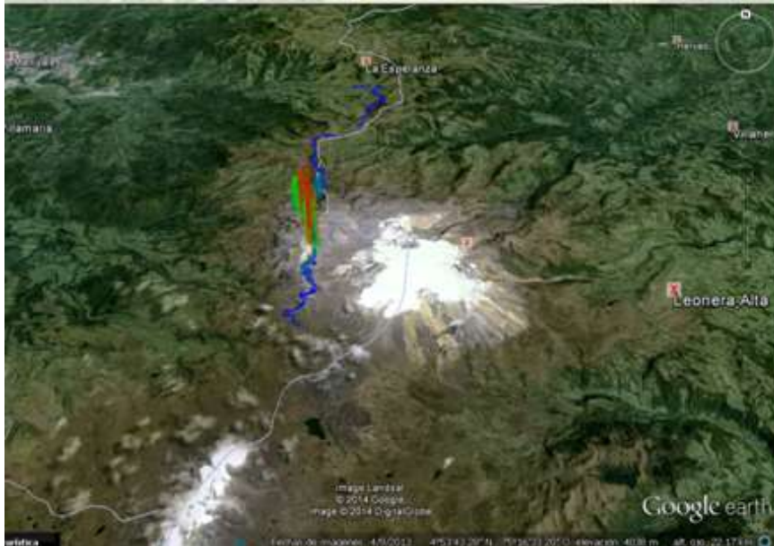
Figura 36. Rutas frecuentes para medida de \text{SO}_2 con equipo MobileDOAS. Volcán Nevado del Ruiz. 2014.
