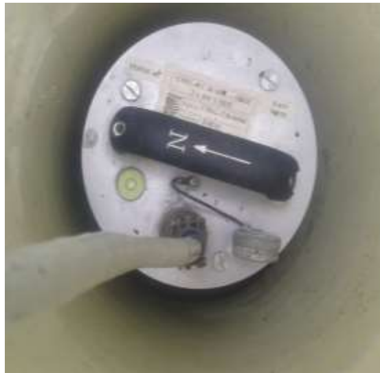
Figura 95. Profundización del sensor de banda ancha en la estación GLACIAR.
